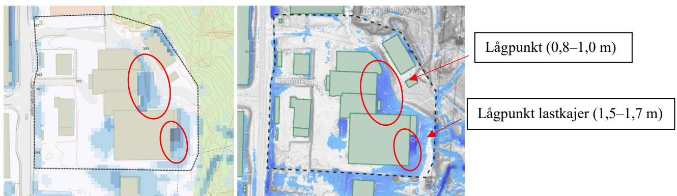
Bild. Maximalt vattendjup vid befintlig skyfallssituation vid 100-årsregn med klimatfaktor. Planområdesgräns visas med svart streckad linje. Strukturplan KoV till vänster och Scalgo DynamicFlood till höger. Göteborgs Stad
